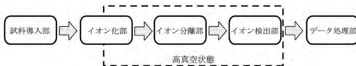
Fig. 2. 質量分析計の構成
