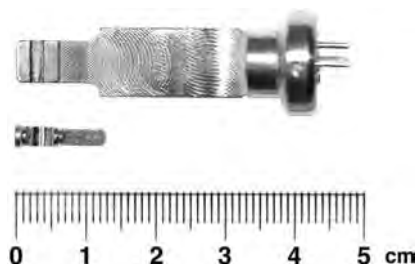
Fig. 6.2. 上：LSIMS用ターゲット 下：FABMS用ターゲット
