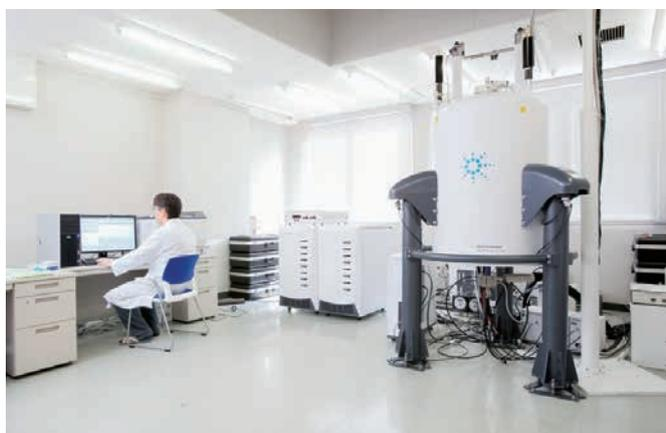
NMR 装置は、天然物化合物、化学合成物質などの低分子化合物から、蛋白質、DNA、ポリペプチドなどの生体高分子化合物に至るまで、幅広い物質の溶液中における立体構造を原子レベルで決定できるだけでなく、生体高分子と低分子間の相互作用様式を分子・原子レベルで解析できる装置であり、創薬分野をはじめ、さまざまな研究分野で広く使用されています。本学には、低分子化合物の網羅的探索が容易に行える汎用性の高い NMR 装置
