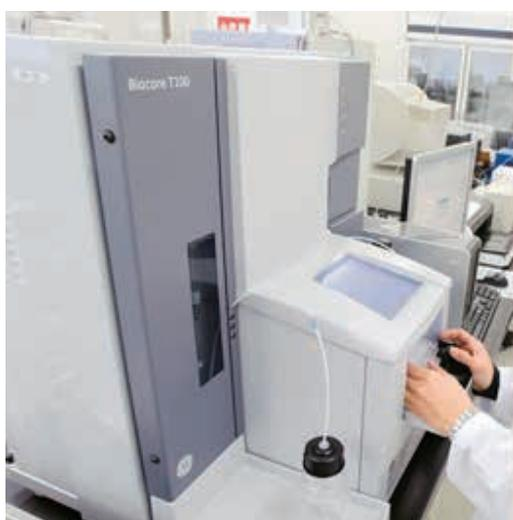
BIACOR-T100 System は、表面プラズモン共鳴 (SPR) センサーを用いた、分子間相互作用を高感度に解析できるシステムです。SPR法は、センサーチップ上に固定化した分子に、対するもう一方の分子を添加して、センサーチップ上で生じる2分子間の相互作用に起因する質量変化を SPR シグナルとして検出する方法です。本装置を用いることにより、タンパク質や核酸などの生体分子間、および低分子化合物との相互作用などについて、その特異性の強さや、結合・解離速度などの重要な情報について簡便かつ迅速に収集することができます。
