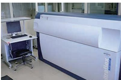
MALDI-TOF MASS は、レーザーを照射して低分子から高分子物質をイオン化することにより、生じたイオンを検出器へ向けて飛ばし、検出器到達までの時間を測定することでイオンの質量を算出します。
