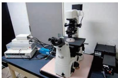
心筋細胞動態・カルシウムイオン同時測定解析システムは高感度 CCD カメラで蛍光色素を結合させた細胞の画像を取得し、細胞内イオンの動きを画像イメージから専用のソフトを使い解析する。
