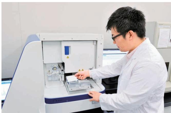
本システムは DNA シーケンサーとして Applied Biosystems 3500 ジェネティックアナライザ、遺伝子発現解析装置として StepOnePlus リアルタイム PCR システムで構築されています。DNA シーケンサーは 8 サンプルを同時に、短時間で解析することができます。遺伝子発現解析装置はハイスループットに解析が可能であり、また、遺伝子配列中の変異も特異的に検出することができます。
