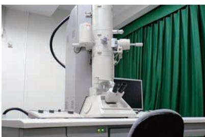
透過型電子顕微鏡（Transmission Electron Microscope; TEM）は、観察したい試料に対して電子線を照射して、透過してきた電子を結像して観察を行う電子顕微鏡である。
