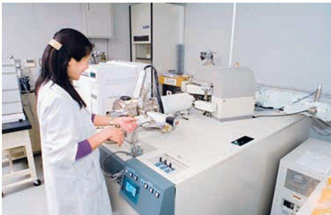
MS (Mass Spectrometry, 質量分析) は、極微量の化合物から、その分子量測定、構造解析、組成式推定、純度確認、定量などができ、化合物の同定に必要不可欠な分析法です。依頼試料は、有機合成化合物、植物からの抽出物、生体関連物質など多岐にわたり、毎日多くの検体が分析され、本学の教育、研究に有効に活用されています。
