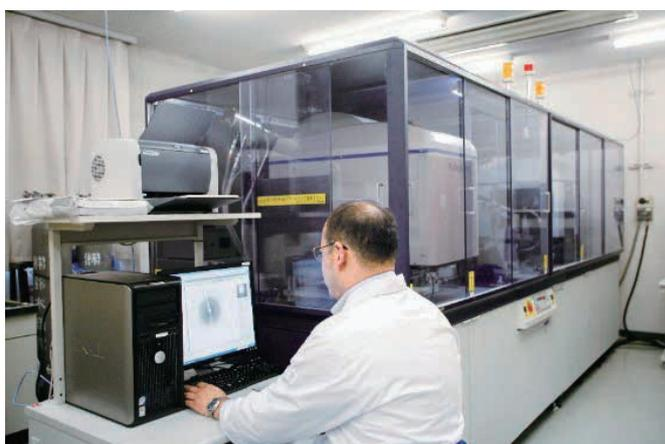
超高輝度の X 線発生装置と、回折 X 線の検出にイメージングプレートを用いた二次元測定機により構成され、高分子結晶から得られる非常に多くの回折データを高速に収集出来る装置です。
