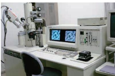
走査型電子顕微鏡（SEM:Scanning Electron Microscope）は電子線を試料に当てて表面を観察する装置であり、X 線検出器を取り付けて元素分析を行うこともできる。
