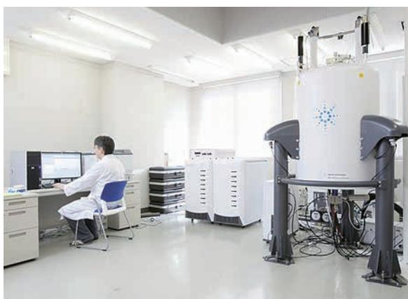
Agilent NMR System 600-DD2 型 NMR 装置
