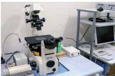
細胞内 Ca 濃度測定システムは、高速デジタル CCD カメラを駆使し心筋細胞の収縮変位とカルシウム濃度をリアルタイムに同時測定が可能なシステムである。
