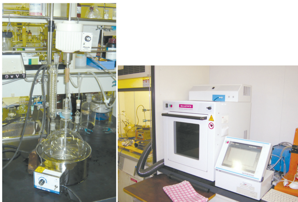
Fig. 2. 攪拌モーターを用いる従前の反応 (左) と MW 反応装置 (Milestone 社, MicroSYNTH multimodal reactor).
